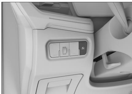
Данная функция обеспечивает автоматическое переключение между ближним и дальним светом фар в зависимости от текущей скорости автомобиля и наружной освещенности.
