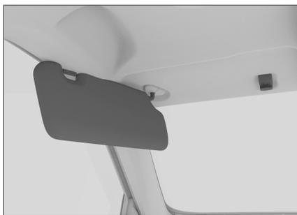
Для защиты от солнечного света, падающего сбоку, опустите солнцезащитный козырек, снимите его с крючка и поверните в сторону бокового стекла.
