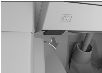
2. Немного приподнимите крышку капота, просуньте под нее руку, сдвиньте рычаг по направлению стрелки и поднимите крышку капота на определенный угол. Капот автоматически откроется.
