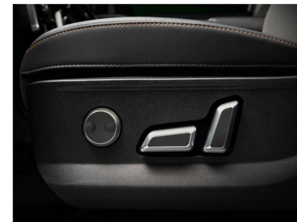
Электрорегулировка сиденья водителя в 8 направлениях
